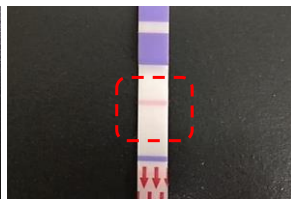
操作 8) 点線の枠内にラインが出現する。 15分後に目視により判定を行う。 (結果判定参照)
