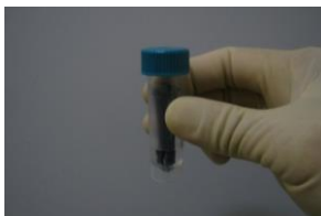
操作 4) 懸濁液の入ったチューブにサンプリングしたネジを最大10本まで入れる。
